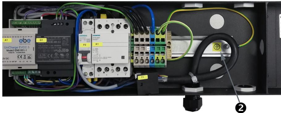
Abbildung 10: Anschlussklemmen für den Schutz-Potentialausgleich
