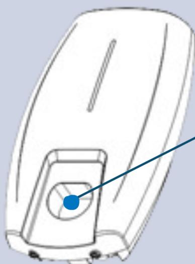
Die integrierte Typ 2-Steckerehalterung ermöglicht Ihnen, den Ladesteckere bei Nichtgebrauch trocken und praktisch aufzubewahren.
