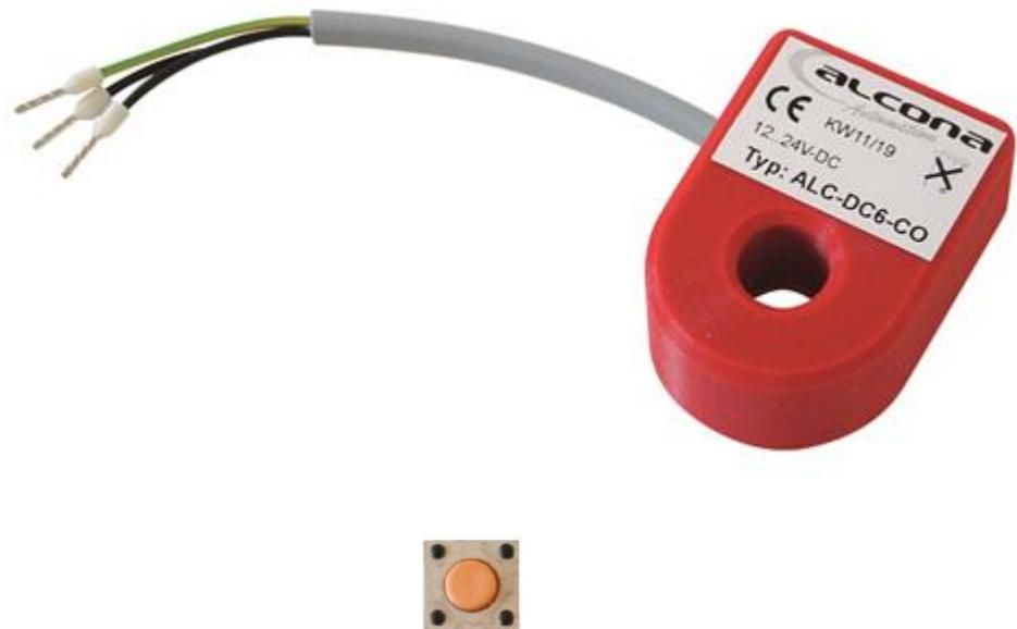
Der im STROMAT integrierte DC-Wächter besitzt einen Test-Knopf zur Überprüfung der Fehlerstromschutzeinrichtung. Bei Betätigen wird ein 6 mA DC-Fehlerstrom generiert. Daraufhin erzeugt der DC-Wächter einen AC-Fehlerstrom, welcher den in der Hausverteilung vorhandenen Fehlerstromschutzschalter auslöst.
